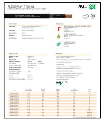
SINGLE CONDUCTOR POWER CABLES
