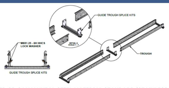
GALVANIZED OR GALVANNEAL STEEL MATERIAL STANDARD (STAINLESS STEEL ON REQUEST)
